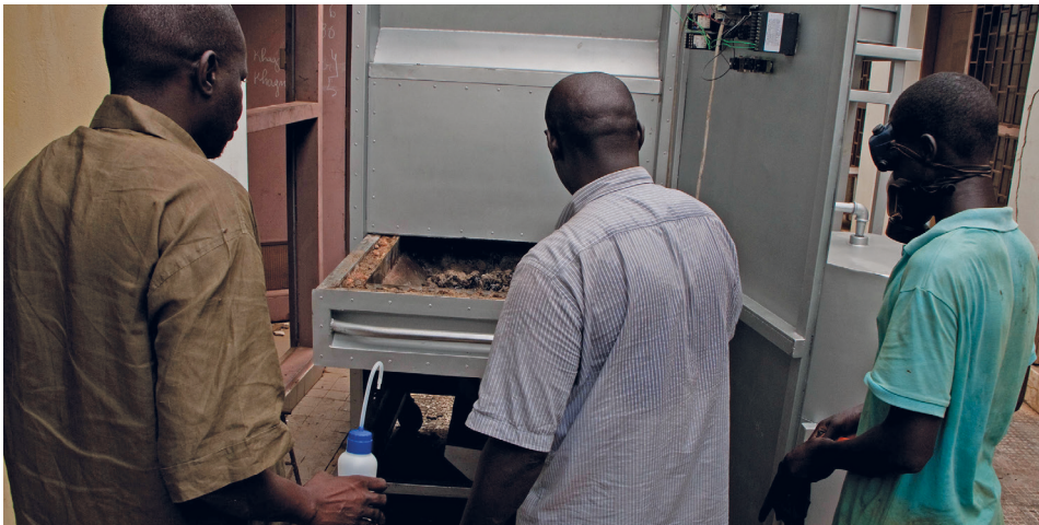
Figure 10.11 : Four à échelle pilote du projet FaME (Faecal Management Enterprises) pour la combustion de boues de vidange afin de chauffer les huiles d'un procédé industriel, Université polytechnique de Thies, Sénégal (photo : Linda Strande).
