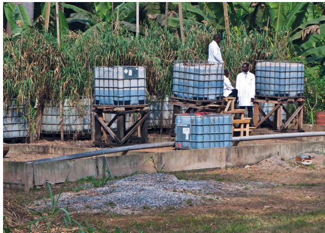
Figure 8.1 : Pilote de lits de séchage plantés pour le traitement des boues de vidange de l'université de Yaoundé I (photo : Linda Strande).
