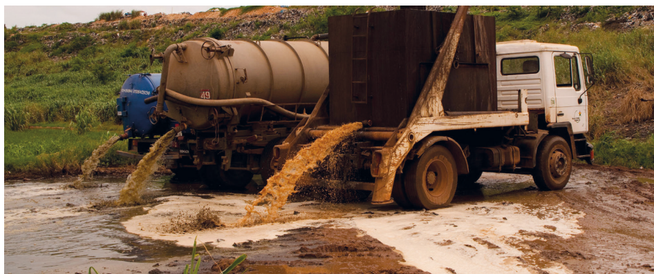
Figure 2.1 : Dépotage de boues de vidange sur le site de déchetterie et de traitement des boues de vidange de Kumasi, Ghana (photo : Linda Strande).
