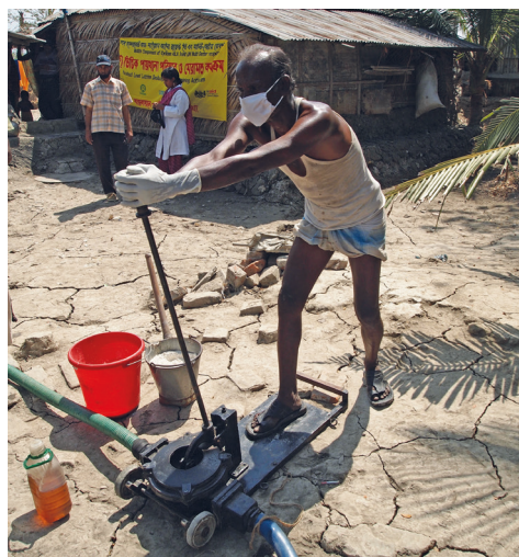
Figure 4.7 : Pompe manuelle à diaphragme en cours d'utilisation au Bangladesh (photo : Georges Mikhael).
