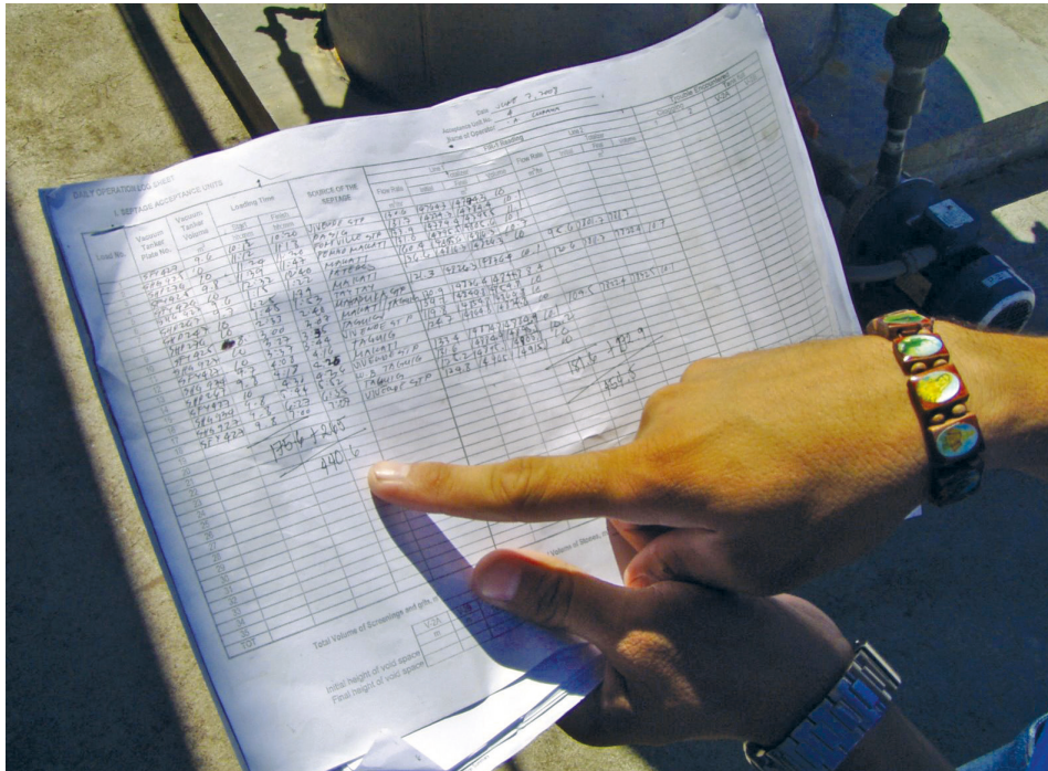
Figure 11.5 : Le registre des entrées des camions consigne le nombre de camions ayant déposé, les volumes de boues de vidange, la date et le jour du dépotage ainsi que le nom du conducteur. Ces rapports sont remplis dans chaque station de traitement des boues de vidange (photo : David Robbins).
