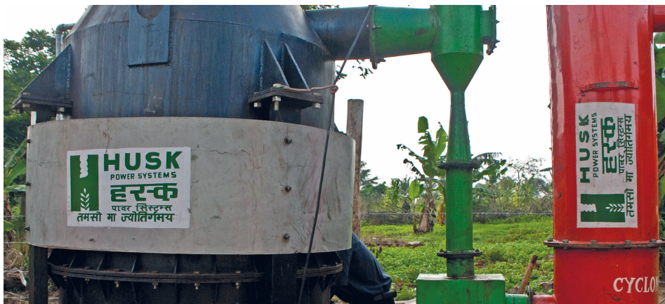
Figure 10.12 : Projet de gazéification Liribogo à partir de feuilles de maïs et de sciure, situé dans le sous-comté de Muduuma, district de Mpigi, Ouganda (photo : Linda Strande).
