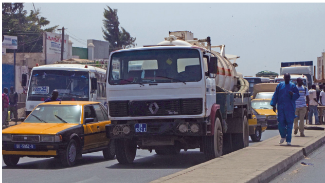
Figure 13.8 : La densité du trafic urbain peut augmenter de façon significative les charges de carburant et de personnel des opérations de collecte et de transport de boues (photo : Linda Strande).
