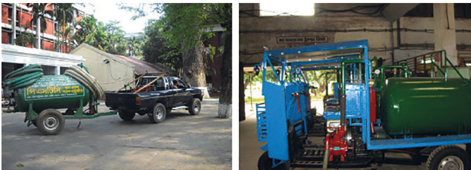
Figure 4.11 : Les modèles BREVAC Mark III (à gauche) et Mark IV (à droite) conçus pour la collecte et le transport des boues (photo : Peter Edwards).
