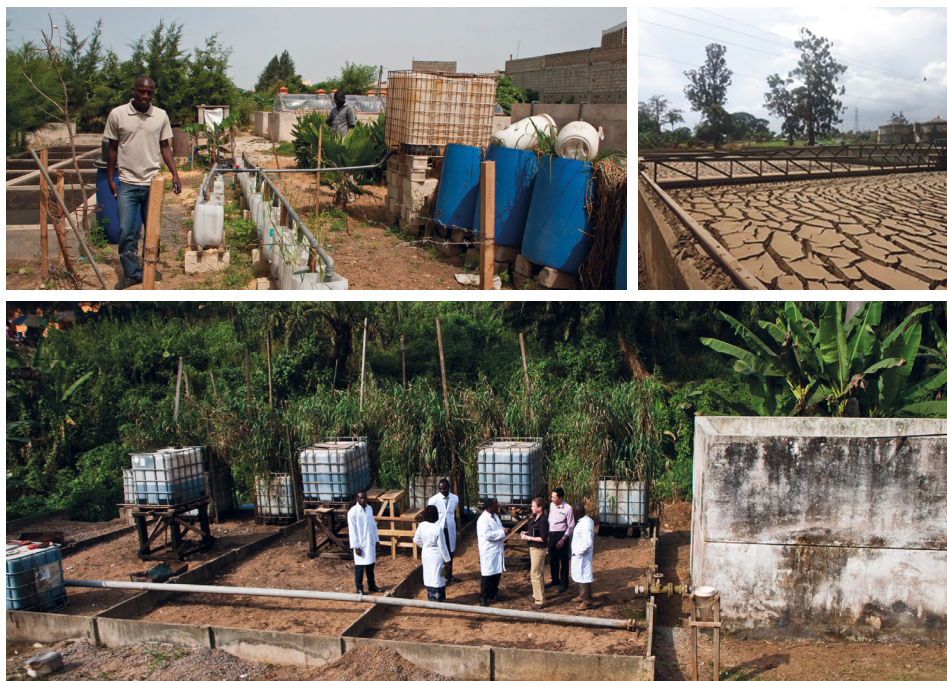
Figure 18.5 : Recherche sur les lits de séchage : Dispositif de mélange pour lits de séchage non-plantés à la station d'épuration de Bugolobi à Kampala, Ouganda ; Évaluation du potentiel de certaines espèces végétales à être utilisées dans des lits plantés à Dakar, Sénégal ; Pilotes de lits plantés pour le traitement du percolat de lits de séchage à Yaoundé, Cameroun (photos : Linda Strande).
