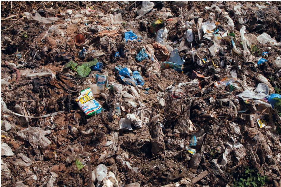
Figure 2.6 : Déchets solides dégrillés à l'entrée d'une station de traitement des boues de vidange de Dakar, Sénégal (photo : Linda Strande).
